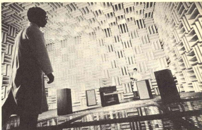
*Fig. 2 - La camera anecoica della JVC ha un'ampiezza decisamente insolita.*
